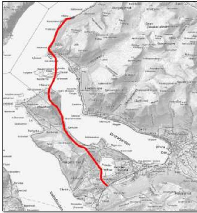
Figur 11 - Alternativ 3 har samanfallande trasé med alternativ 2 fram til Steinnes. Der kjem den ut i dagen og går i dagen fram til Flåvika. Frå Rjånes til Flåvika er traséen samanfallande med alternativ 1.
